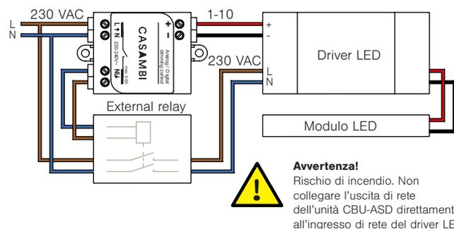
Nota 1. L'unità CBU-ASD è un dispositivo di classe II integrato. Se non viene installata all'interno di un altro dispositivo isolato, utilizzare cavi a doppio isolamento o una scatola di installazione esterna.
